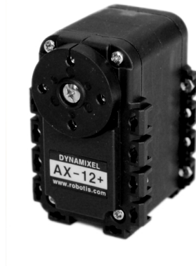
Abbildung 1.1: DYNAMIXEL AX-12: Dieser übliche Servomotor, besteht aus einem DC-Elektromotor, welcher an ein Kunststoff-Stirnradgetriebe gekoppelt ist. Eine Steuerplatine mit einem Mikroprozessor übernimmt die Regelung und kann über einen seriellen Bus kommunizieren.
